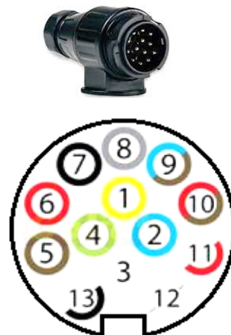
Schema 2. Elektroinstallation 13-Pin-Anschluss
