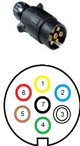
Schema 1. Elektroinstallation 7-Pin-Anschluss
